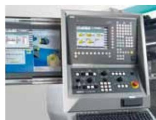
3. Als Erweiterung der INDEX Virtuellen Maschine direkt neben der Maschinensteuerung (mit Simulation)
